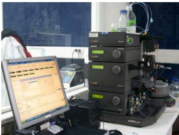
Figura 6.1 Equipo ÄKTApurifier de GE Healthcare Fuente: Manual de ÄKTApurifier Getting Started.
